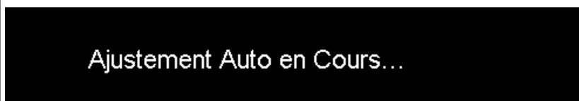
Réglage auto permet au moniteur de se régler automatiquement sur le signal vidéo reçu. Après avoir utilisé la fonction Réglage auto, vous pouvez régler votre moniteur plus précisément en utilisant les contrôles Horloge de pixels (gros réglage) et Phase (Réglage précis) dans **Réglages de l'affichage**.
